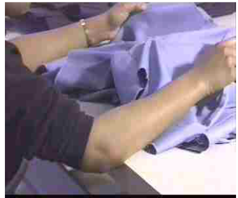
(شکل شماره 3) قرار گرفتن ساعد بر روی لبه های تیز میز کار باعث آسیب به دستها می شود .
